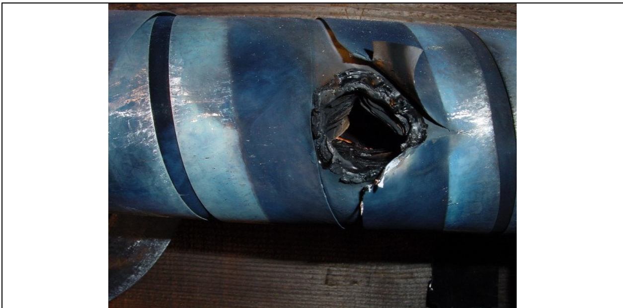
Figure 16: Endommagement de câble lors de l'essai de court circuit en configuration en courant continu
