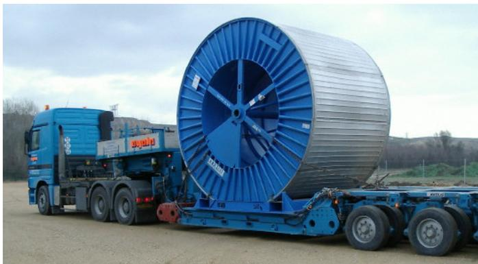
Figure 19 : Approvisionnement des câbles en chantier
