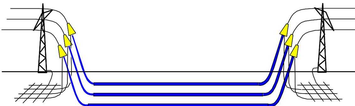
*Figura 35 :esquema de un sifón*
