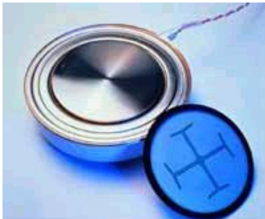
Figure A4 exemple de thyristor moderne 8 kV
