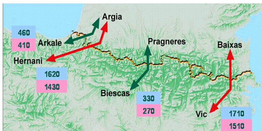
Fig. 3-1 – Lignes transfrontalières à THT entre la France et l’Espagne avec indication de la capacité thermique en MVA (en bleu : capacité thermique en hiver ; en rose ; capacité thermique en été)
