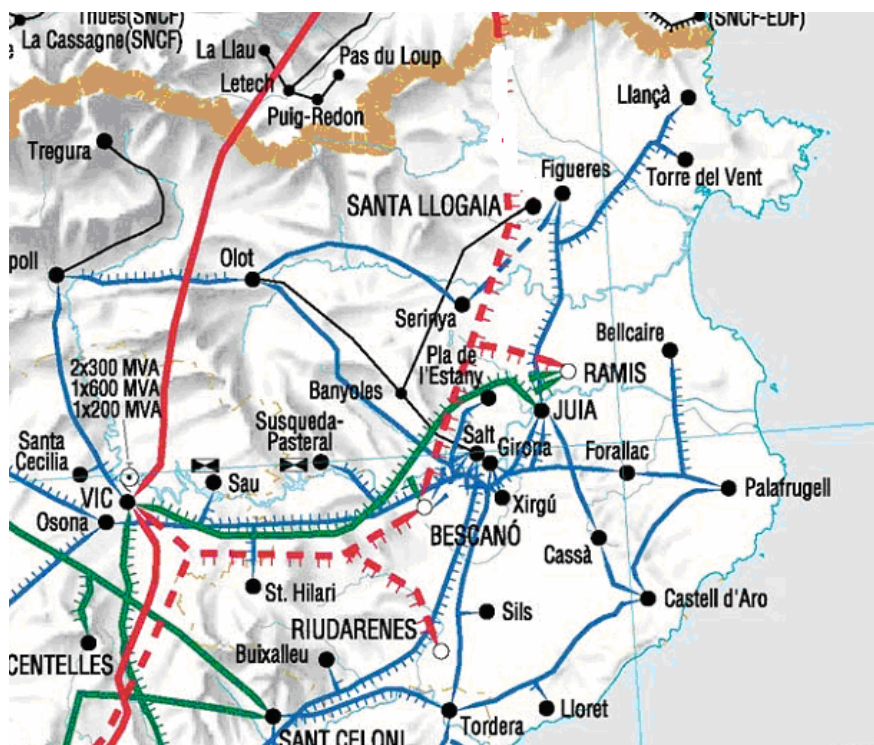
Fig. 5-17 Carte du réseau de la région de Gerona (400kV en rouge, 220kV en vert, 132-110 kV en bleu) (source REE)
