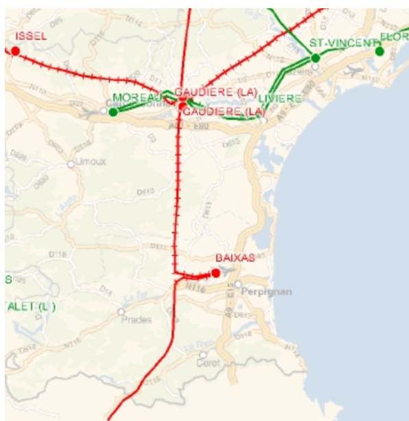
Fig. 5-15 Carte du réseau THT (400kV/225kV) du Roussillon
