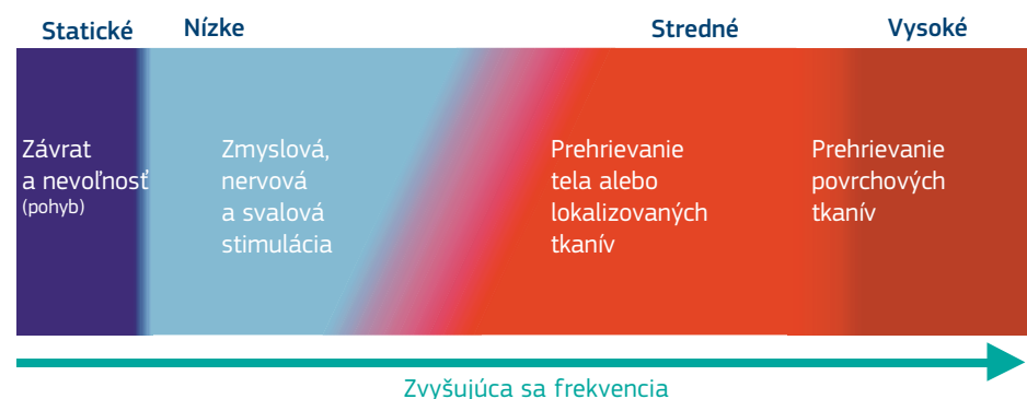
Obrázok 2.1 – Účinok EMP v jednotlivých frekvenčných rozsahoch (pri intervaloch frekvencie nie sú zachované pomery)
