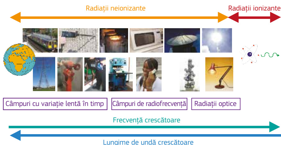
Figura 3.1. – Reprezentare schematică a spectrului electromagnetic incluzând câteva surse tipice
