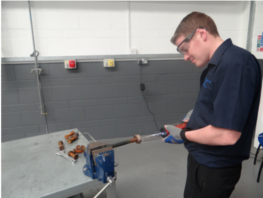
Obrázok 6.3 Ručný indukčný ohrievač s výkonom 1 kW používaný na zohriatie zaseknutej skrutky
