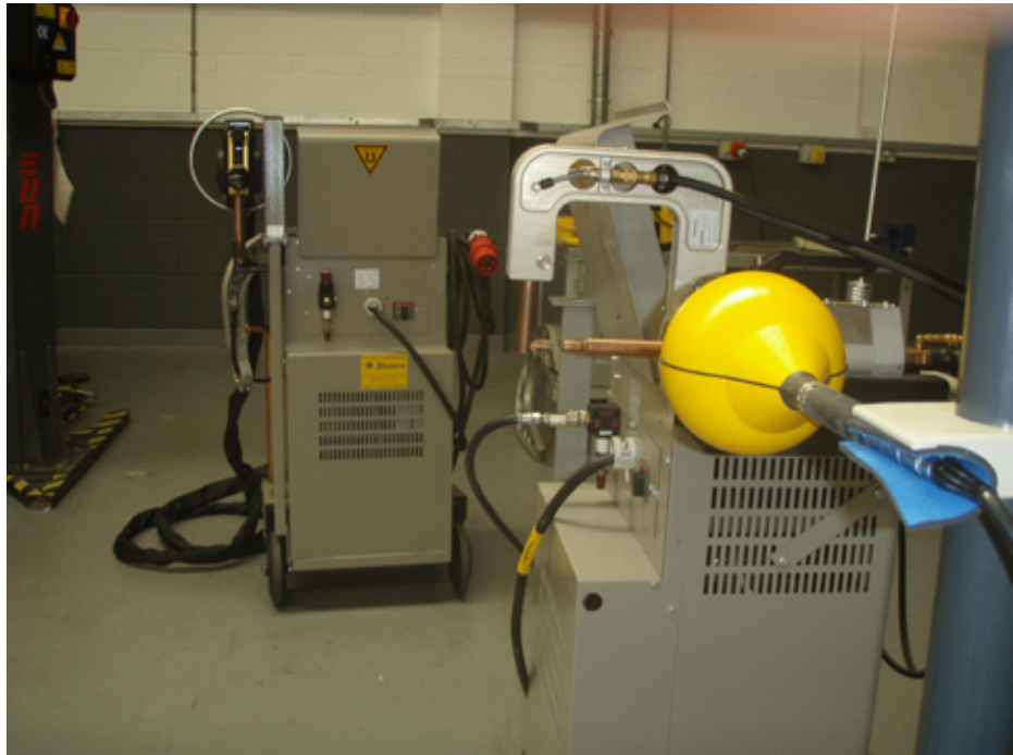
Obrázok 6.7 Merania okolo bodovej zväračky v opravovni s pištoľou typu „C“ a namontovaným ramenom veľkosti 160 mm. Zväracia pištoľ typu „X“ je v pozadí
