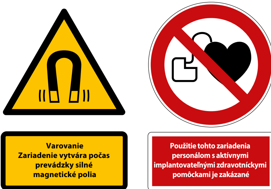
Obrázok 5.7 Príklad varovných a zákazových oznámení
