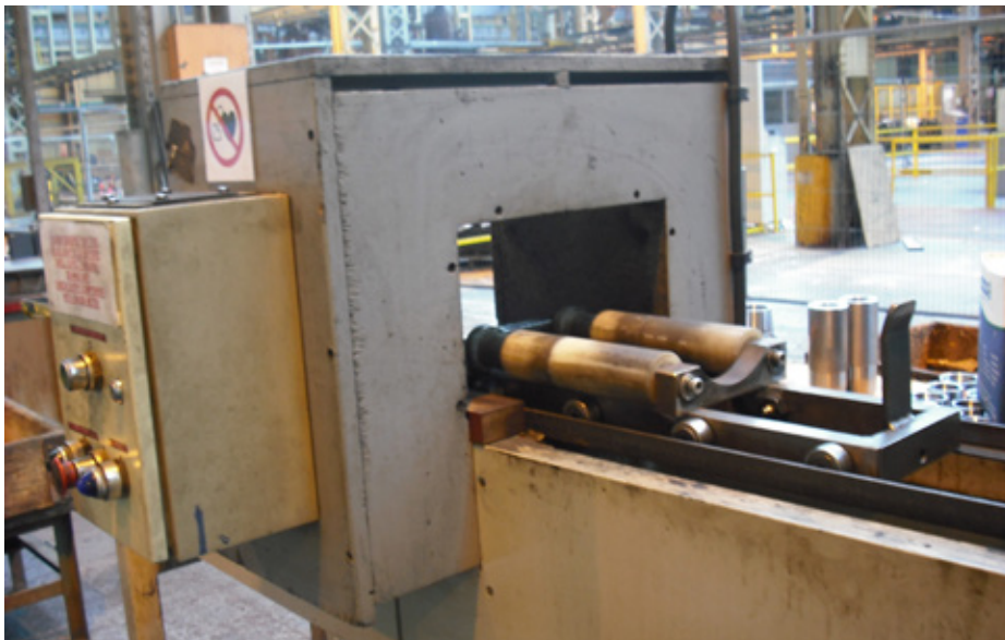
Obrázok 5.2 Demagnetizér s posuvným vozíkom
