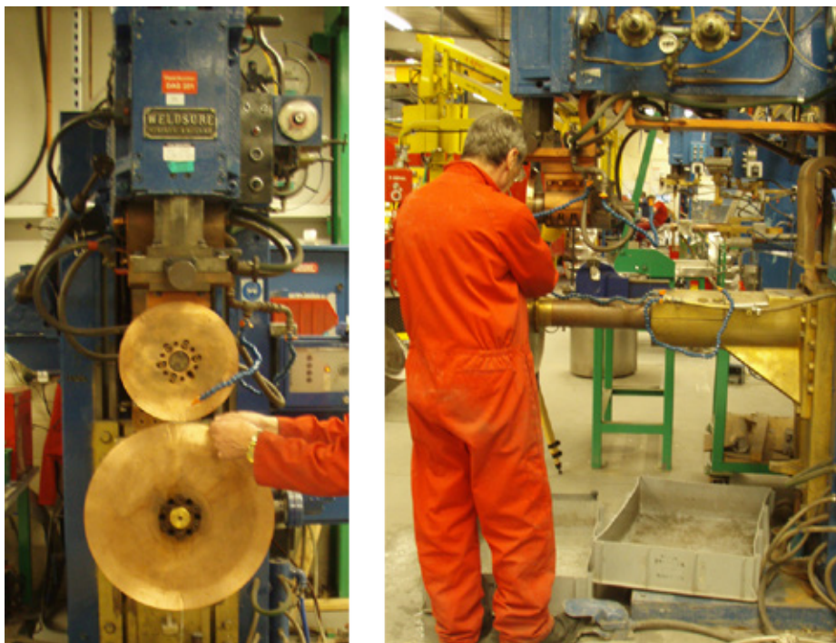
Obrázok 7.3 Pohľad spredu a z boku na švovú zväračku
