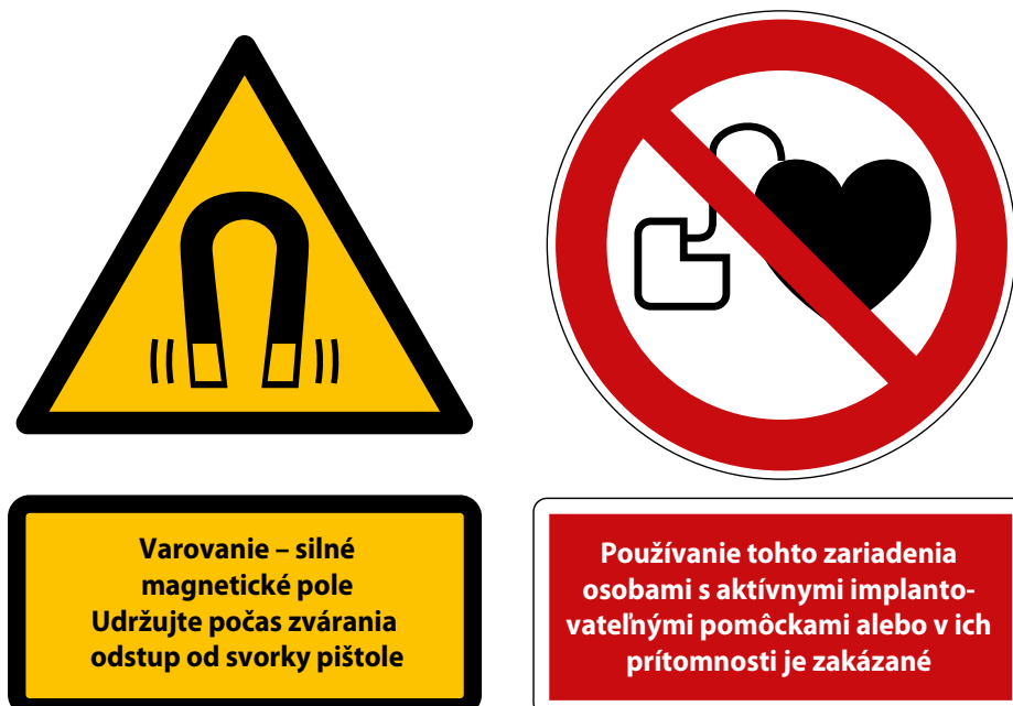
Obrázok 6.15 Príklady oznámení upozorňujúcich na silné magnetické polia a oznámení zakazujúcich používanie zväračky osobami s aktívnymi implantovateľnými zdravotníckymi pomôckami alebo v ich prítomnosti
