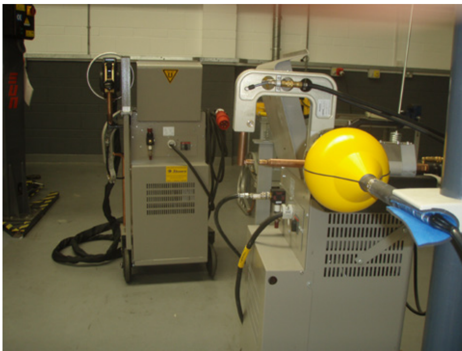
Figura 6.7. – Măsurători în jurul aparatului de sudură în puncte utilizat în cadrul atelierului de reparații echipat cu pistol „de tip C” și braț de 160 mm. Pistolul de sudură „de tip X” este ilustrat în fundal
