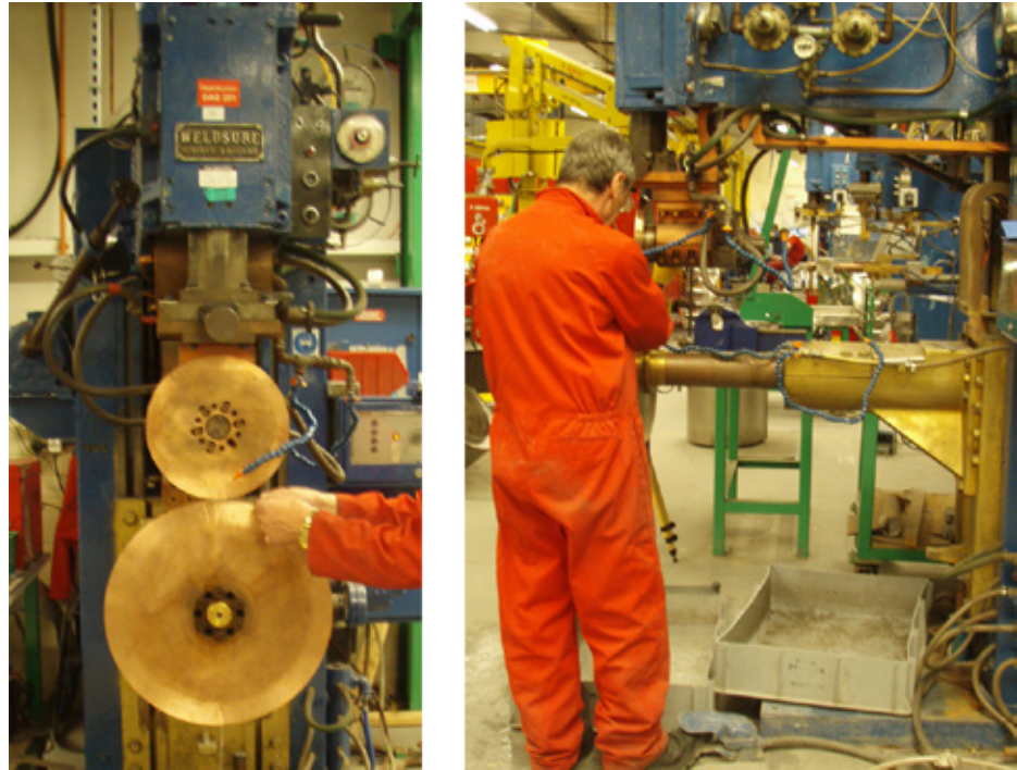
Figura 7.3. – Vederi frontală și laterală ale aparatului de sudură în linie
