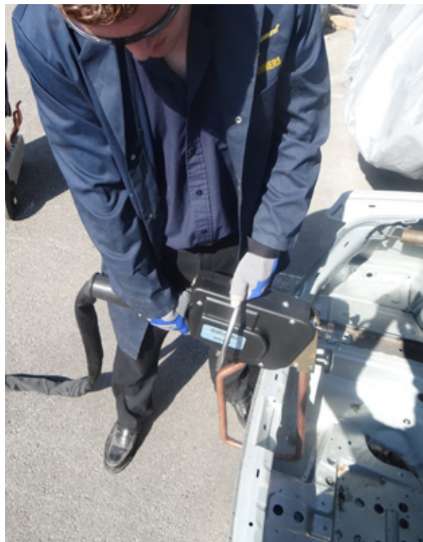
Figura 6.1. – Un aparat portabil de sudură în puncte utilizat pentru a monta un panou nou
