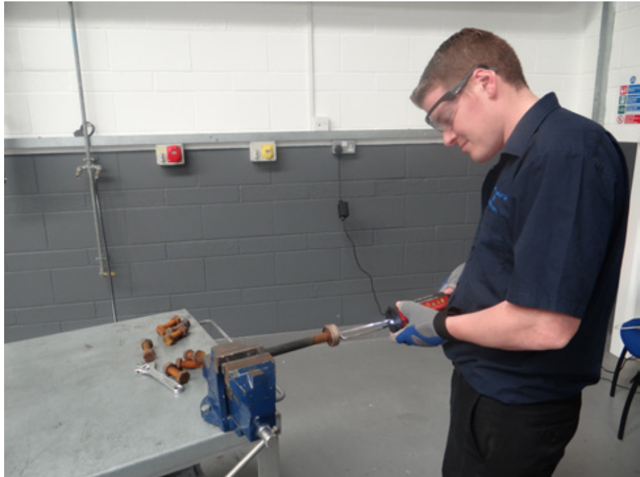
Figura 6.3. – Un încălzitor portabil cu inducție de 1 kW utilizat pentru a încălzi un bulon blocat
