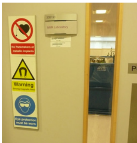
Figura 2.3. – Semne de avertizare și de interdicție pe ușa de intrare în laboratorul RMN
