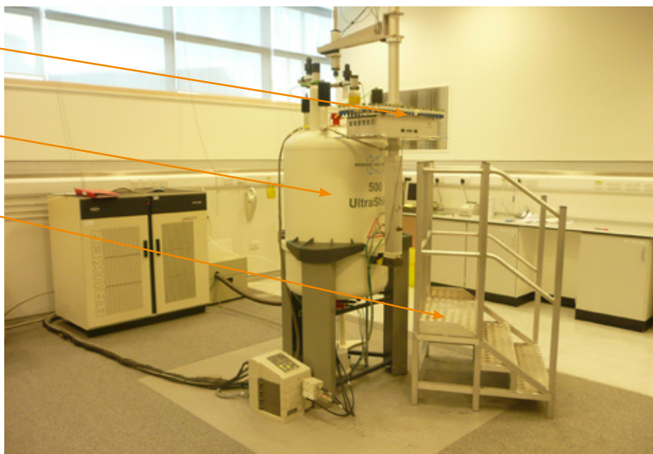
Rysunek 2.1 – Urządzenie do MRJ wyposażone w karuzelę na próbki i pomost do wprowadzania próbek
