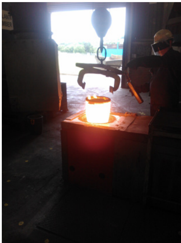
Rysunek 8.5 – Zadania, których wykonywanie wiąże się z przebywaniem w pobliżu pieca, były realizowane przy wyłączonym zasilaniu pieca
