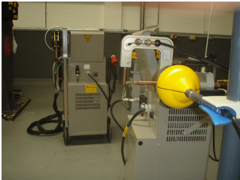
Rysunek 6.7 – Pomiary wykonane w pobliżu warsztatowej zgrzewarki punktowej wyposażonej w zgrzewadło „typu C” z zamocowanym ramieniem o długości 160 mm. Zgrzewarka wyposażona w zgrzewadło „typu X” znajduje się w tle
