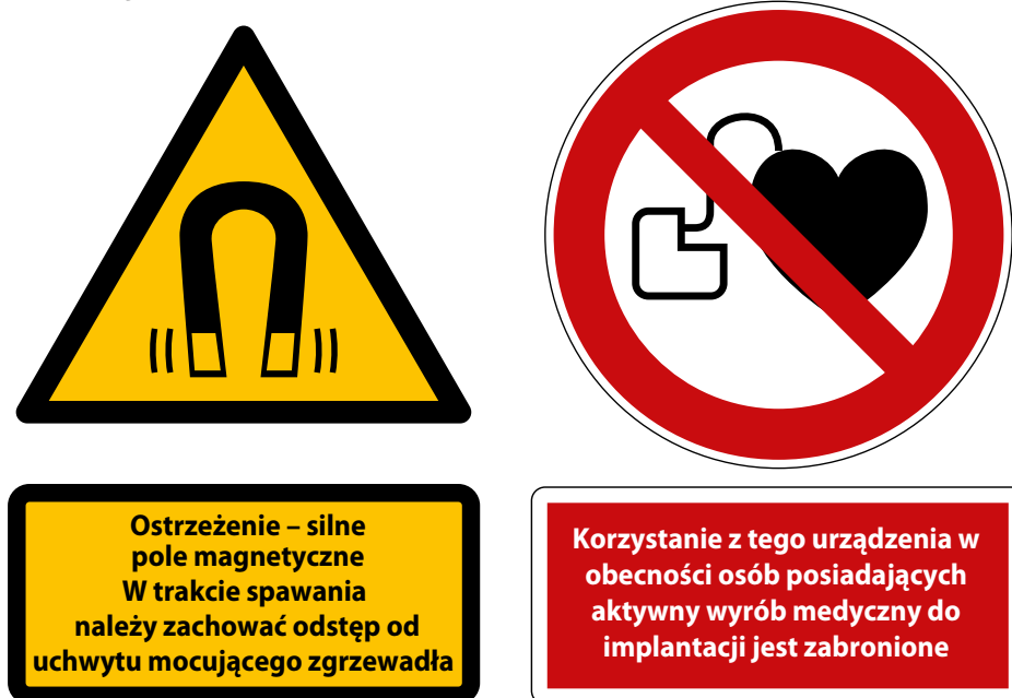
Rysunek 6.15 – Przykłady znaku ostrzegawczego informującego o silnych polach magnetycznych i znaku informującego o zakazie korzystania ze zgrzewarki przez osoby korzystające z aktywnego wyrobu medycznego do implantacji lub w obecności tych osób
