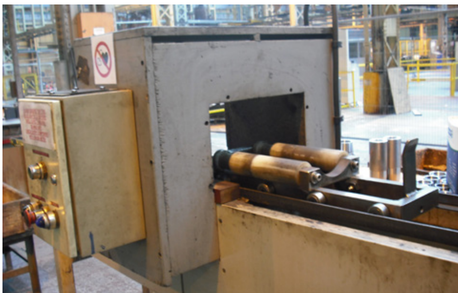
Rysunek 5.2 – Demagnetyzator wyposażony w wózek przesuwny
