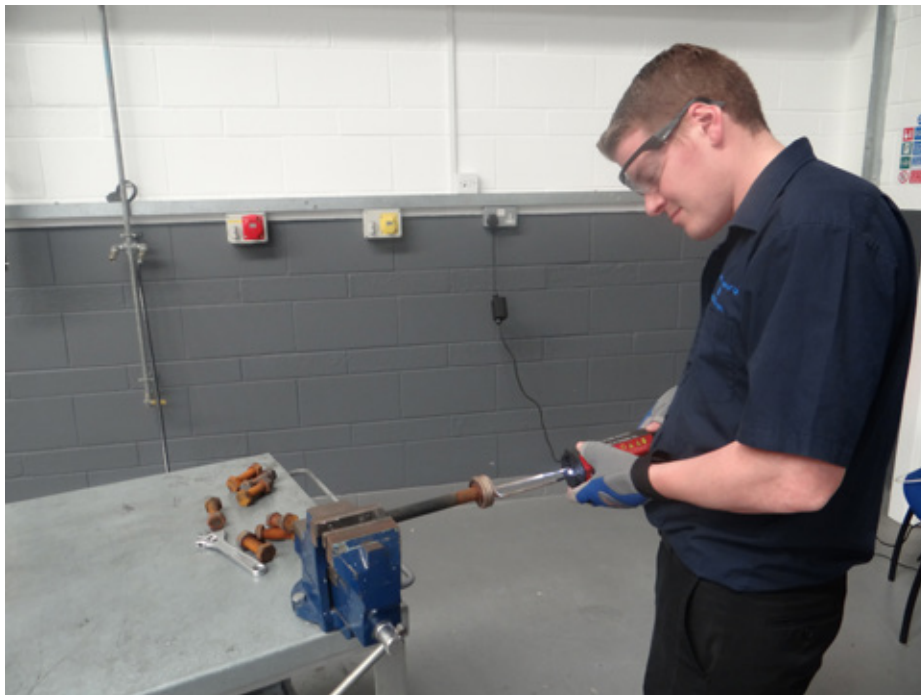
Rysunek 6.3 – Ręczna nagrzewnica indukcyjna o mocy 1 kW wykorzystywana do podgrzewania zakleszczonej śruby
