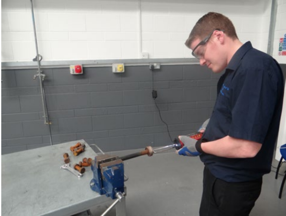
Figura 6.3 Hiter tal-induzzjoni portabbli ta' 1 kW użat sabiex isaħħan bolt li ma setax jinqala'
