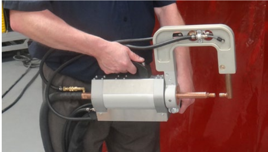
Figura 6.4 Il-gun tal-iwweldjar tat-“tip C” tat-tillar, bl-arm ta' 160 mm imqabba. Il-parti ewlenija tal-gun (taħt id il-haddiem) fiha l-pistun li jagħfas elettrodu fuq ieħor. Il-kurrent tal-iwweldjar jitwassal mill-unità ta' kontroll permezz tal-kejbils fuq ix-xellug tal-istampa
