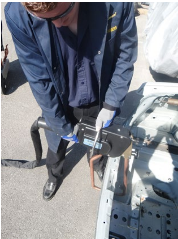
Figura 6.1 Spot welder portabbli li jintuża biex titwaħħal pannella ġdida f'postha
