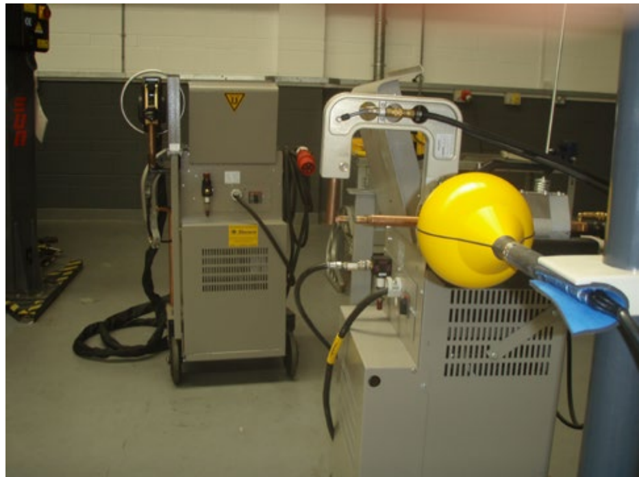
Figura 6.7 Kejliet madwar l-ispot welder tat-tilliar mgħammar b'gun tat-“tip C” u l-arm ta' 160 mm installata. Il-welder bil-gun tat-“tip X” huwa fl-isfond
