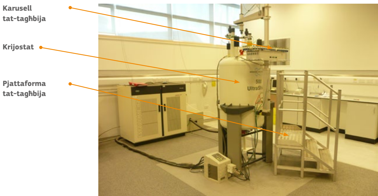
Figura 2.1 Unità tal-NMR, flimkien ma' karusell tal-kampjuni u pjattaforma tat-tagħbija
