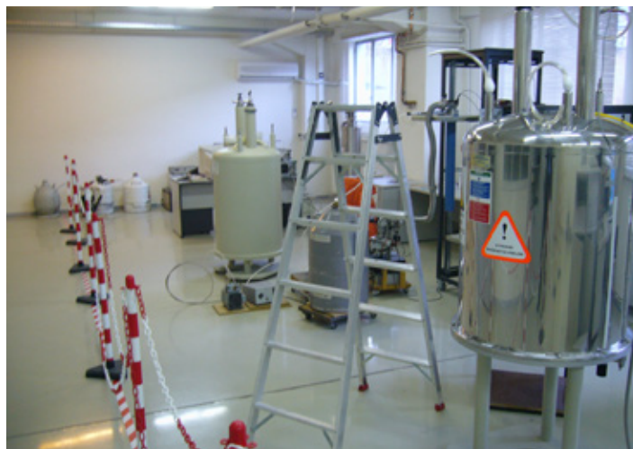
2.4 paveikslas. Ribojamos prieigos zonos ribų žymėjimas grandinine užtvara ir ženklinant grindis
