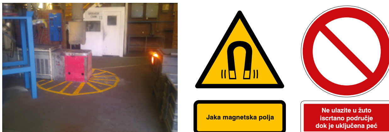
Slika 8.7. – Iscrtani pod i povezane obavijesti upozorenja kojima se označava područje u kojem se vrijednosti upozorenja mogu premašiti
