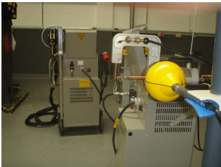
Slika 6.7. – Mjerenja oko radioničkog aparata za točkasto zavarivanje s ugrađenim pištoljem „tipa C” i držačem od 160 mm. Pištolj „tipa X” aparata za zavarivanje je u pozadini
