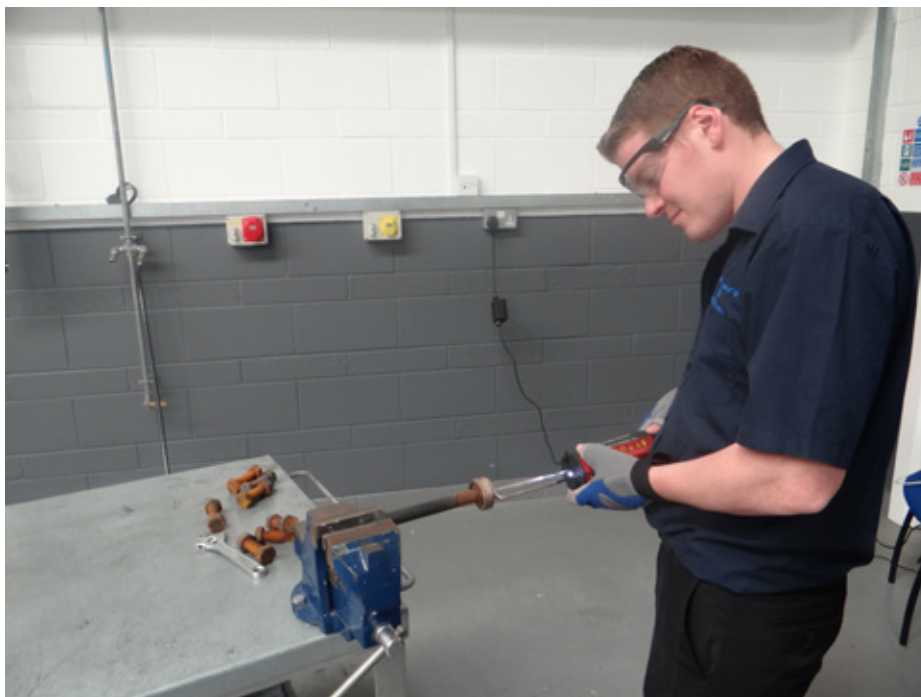
Slika 6.3. – Ručni indukcijski grijač od 1 kW kojim se koristi za zagrijavanje zategnutog vijka
