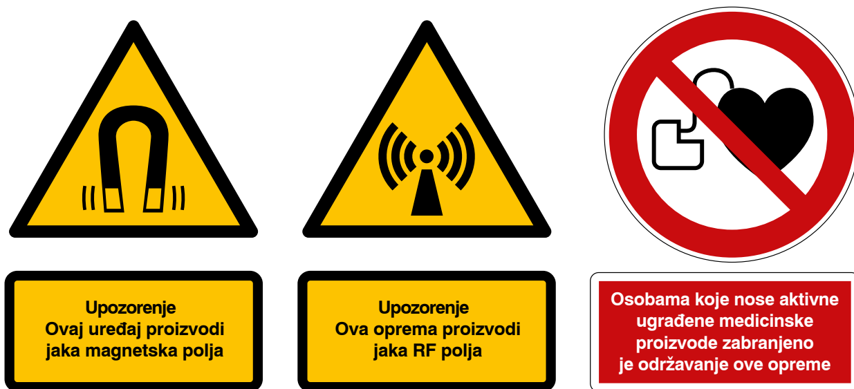
Slika 9.5. – Primjeri obavijesti upozorenja za jaka magnetska polja i jaka RF polja te primjer simbola zabrane za osobe s aktivnim ugrađenim medicinskim proizvodima
