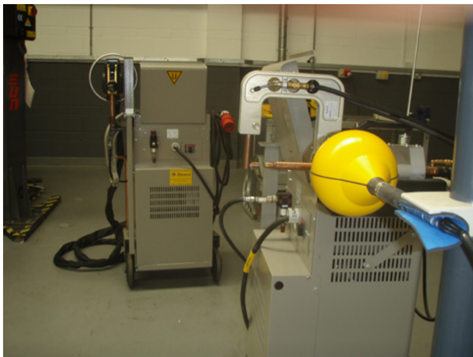
Illustration 6.7 — Mesures autour du poste de soudage par points d'atelier de réparation, équipé d'un pistolet de «type C» et d'un bras de 160 mm. Le poste de soudage de «type X» est visible à l'arrière-plan.
