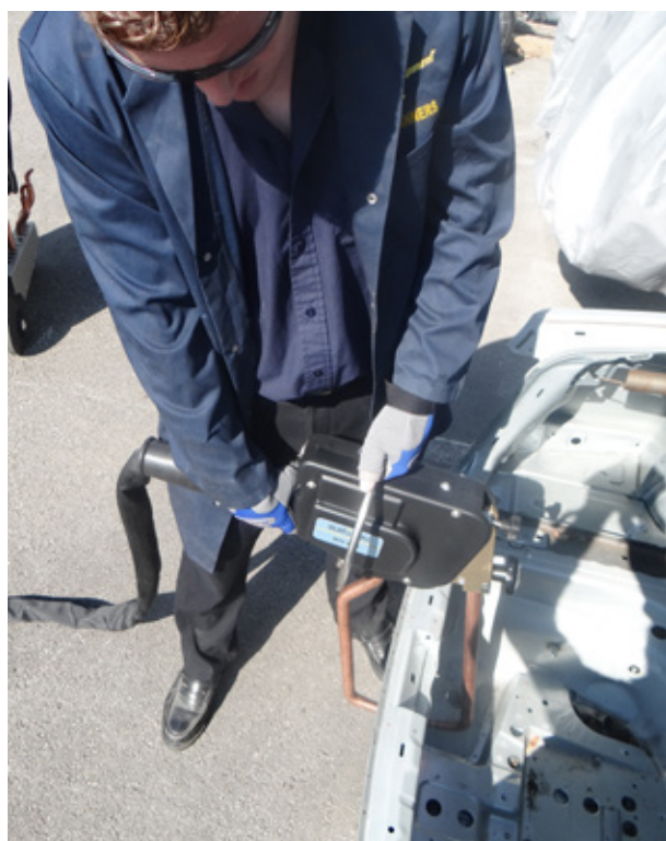
Illustration 6.1 — Un poste mobile de soudage par points utilisé pour fixer un nouveau panneau
