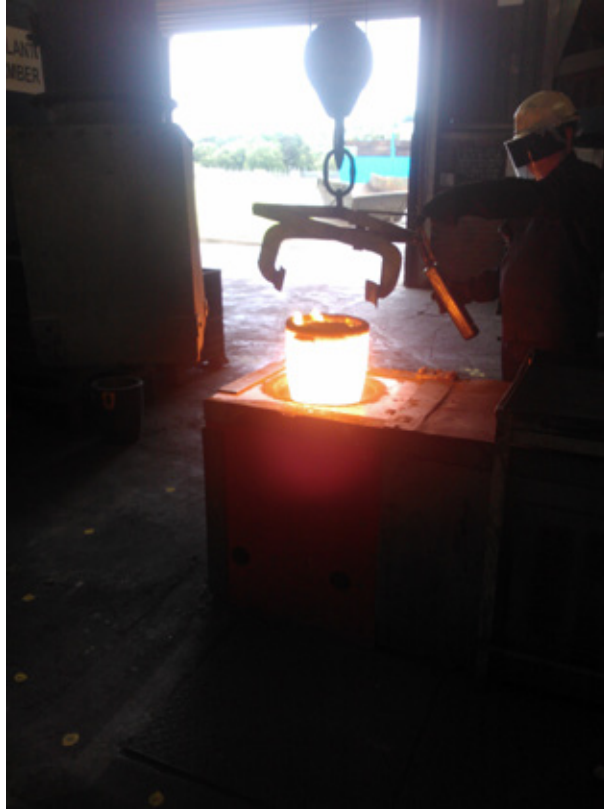
Kuva 8.5 Tehtävät, jotka edellyttävät uunin lähelle menemistä, tehtiin uunin ollessa kytkettynä pois päältä
