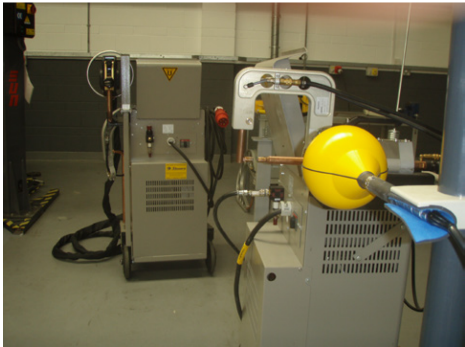
Kuva 6.7 Korjaamon pistehitsauslaitteen ympärillä tehdyt mittaukset (laitteessa C-mallin pistooli ja 160 mm:n varsi) X-mallin pistooli näkyy taaempana
