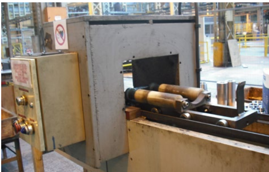
Figur 5.2. Afmagnetiseringsapparat med vogn
