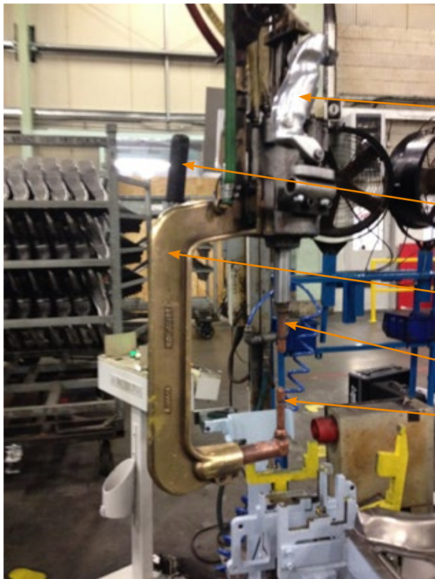
Figur 6.17. Svejsetang af X-typen på 700 mm på fabrikken. Selvom svejsetangen understøttes af et balcestykke, betyder størrelsen af svejsetangen, at arbejdstagere rutinemæssigt skal stå tæt på elektroderne for at føre dem og holde dem på plads
