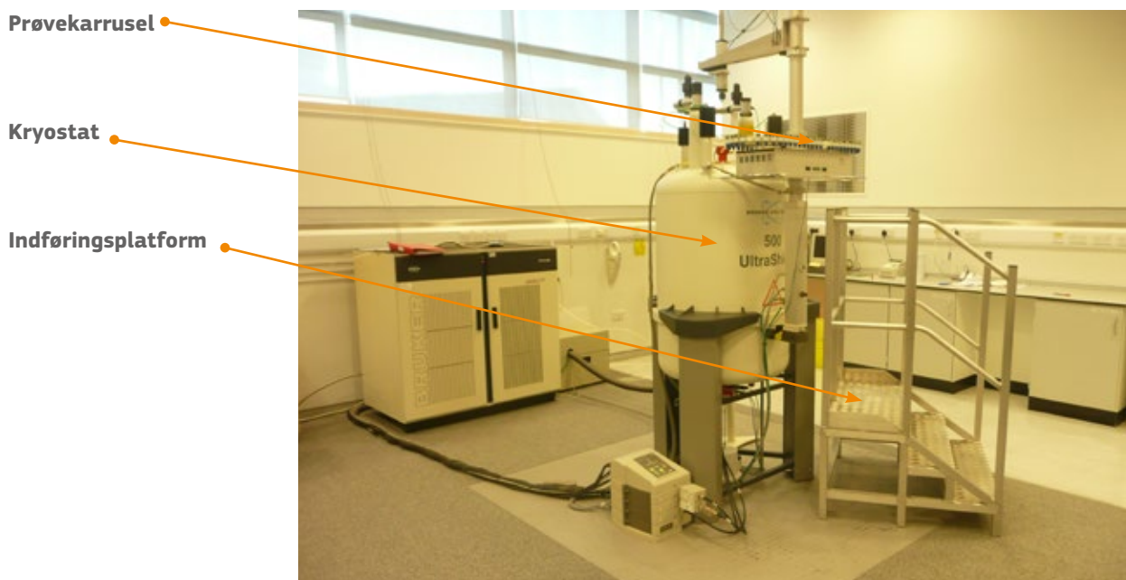
Figur 2.1. NMR-apparat med prøvekarrusel og indføringsplatform
