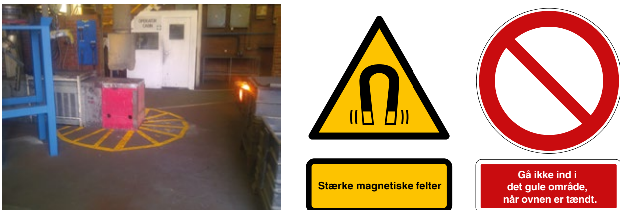
Figur 8.7. Markeringer på gulv og tilhørende advarselsskilt for at angive det område, hvor aktionsniveauerne kan blive overskredet
