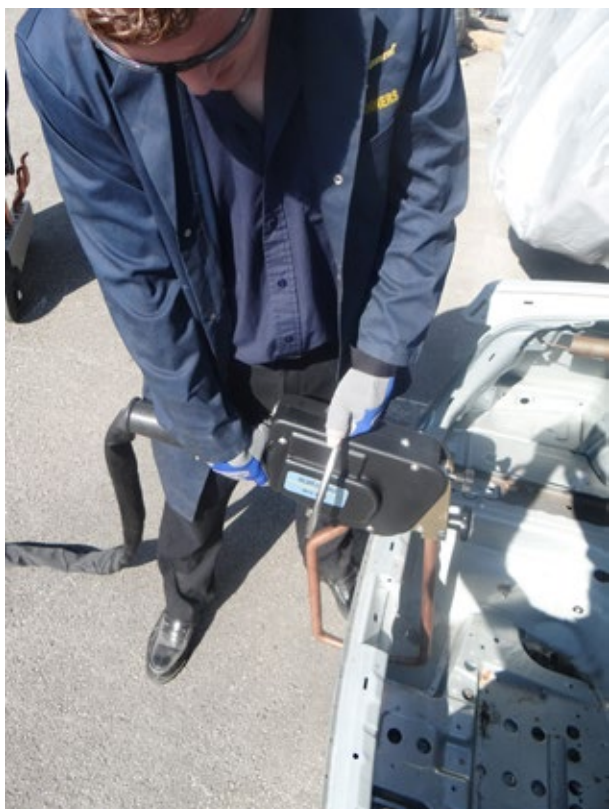
Figur 6.1. Håndholdt punktsvejsere, der anvendes til at fastgøre et nyt panel
