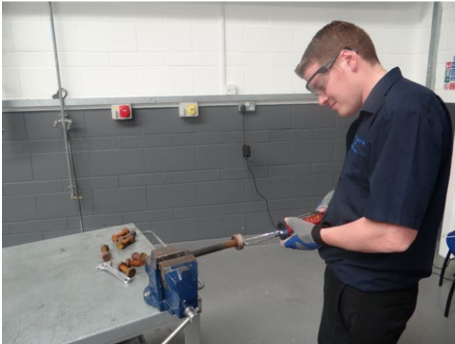
Figur 6.3. En 1 kW håndholdt induktionsvarmer, der anvendes til at opvarme en bolt
