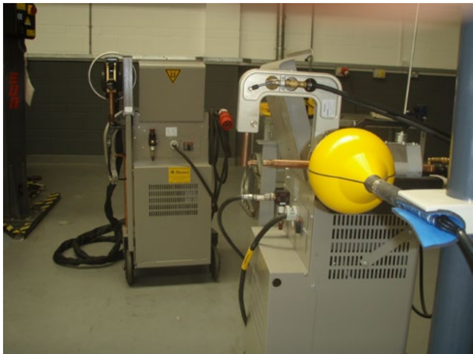
Figur 6.7. Målinger omkring punktsvejser med svejsetang af C-typen og 160 mm arm på værksted. Svejser med svejsetang af X-typen er i baggrunden.
