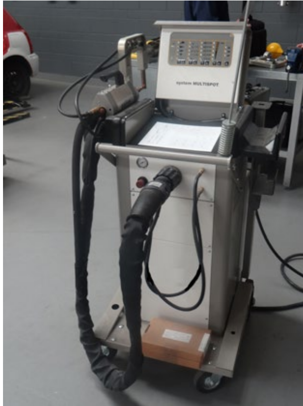
Figur 6.2. En typisk håndholdt punktsvejser på et karrosseriværksted. Systemet er mobilt, idet kontrolenheden er monteret på hjul. Forsyningskablerne til el- og kølesystemet går fra fronten af enheden til bagenden af svejsetangen, som sidder i en holder til venstre for kontrolpanelet.
