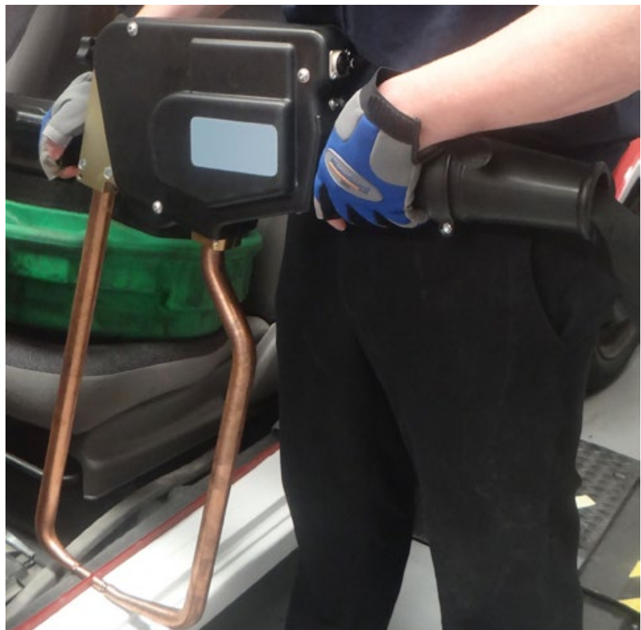
Figur 6.5. Svejsetang af X-typen med påmonterede elektroder på 550 mm. De to elektroder presses sammen i en knibtangsmanøvre af et stempel i selve svejsetangen (mellem arbejdstagerens hænder), som også indeholder den transformator, der forsyner svejsestrømmen.
