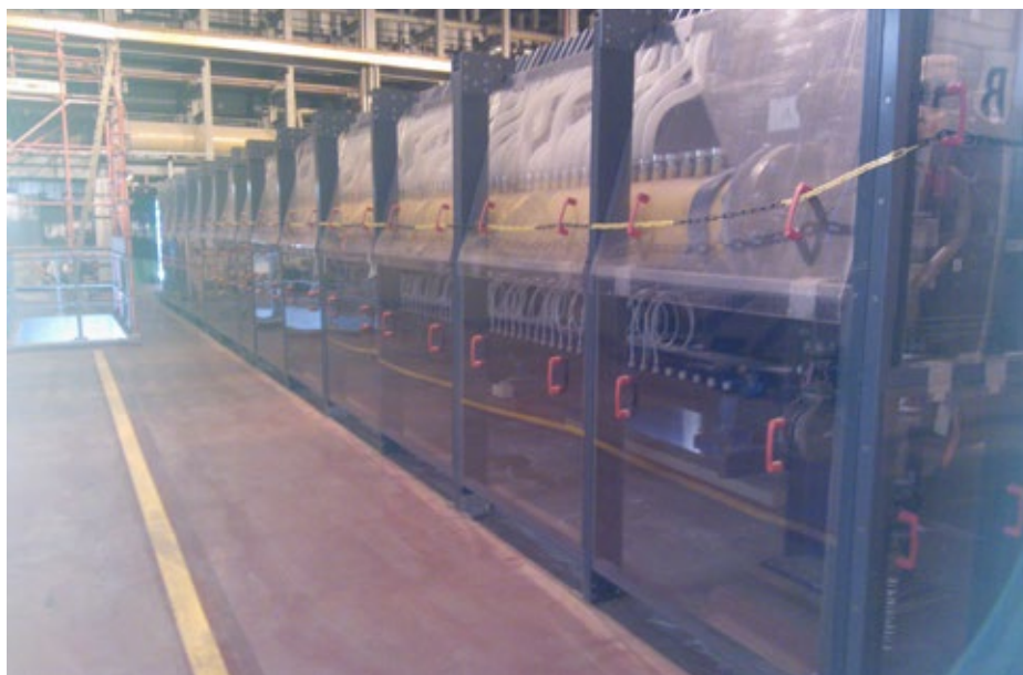
Figur 3.1. Elektrolyseceller i cellerum
