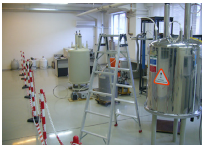
Obrázek 2.4 Vyznačení vyhrazené oblasti řetězovými zábrami a podlahovými páskami
