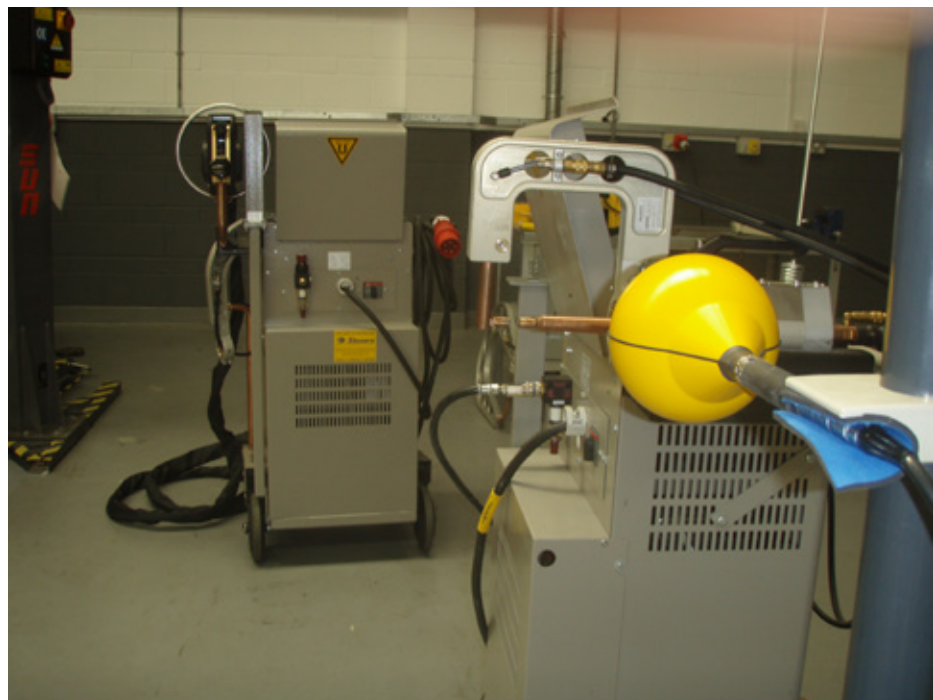
Obrázek 6.7 Měření v okolí bodové svářečky v autodílně vybavené „C-kleštěmi“ a ramenem o délce 160 mm. V pozadí jsou svářecí „X-kleště“
