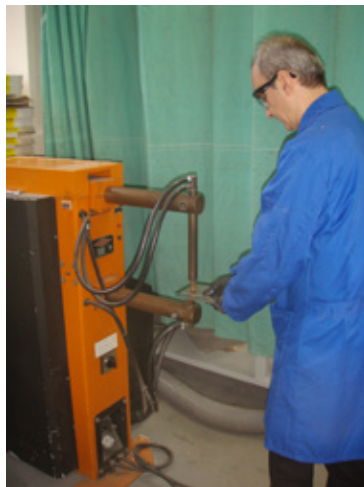
Obrázok 9.10 Príklady správneho postupu a nesprávneho postupu pri zariaďovaní pracovného stanovišťa bodovej zvaračky a zohľadnení polohy obsluhy
