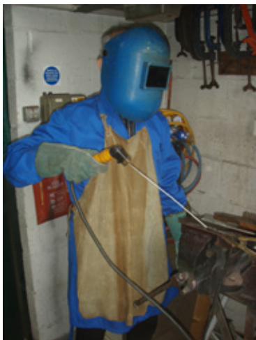
Obrázok 9.11 Príklady správneho a nesprávneho postupu pri vedení kábla pri oblúkovom zváraní
