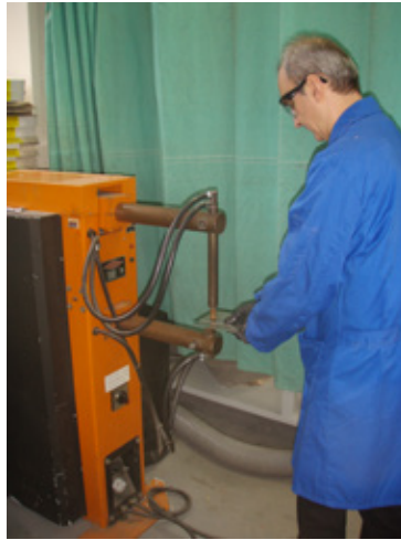
Figura 9.10. – Exemple de bune practici și de practici incorecte la amenajarea postului de lucru pentru un aparat de sudură în puncte și luarea în considerare a poziției operatorului
