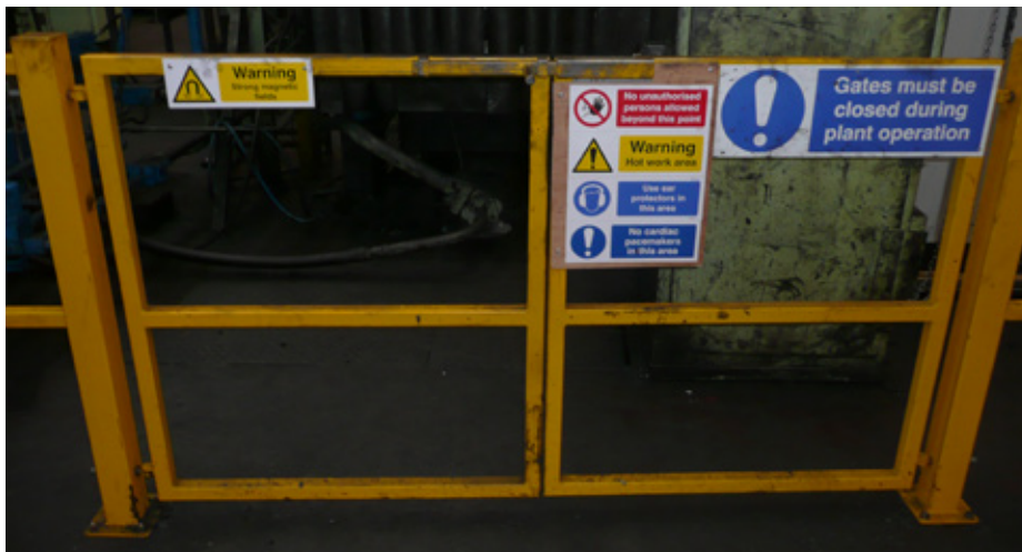
Figura 9.1. – Exemplu de dispozitiv de protecție mobil simplu utilizat pentru a restricționa accesul la un câmp magnetic puternic. În acest caz, dispozitivul nu este racordat, dar este completat cu semne de avertizare și măsuri organizatorice
