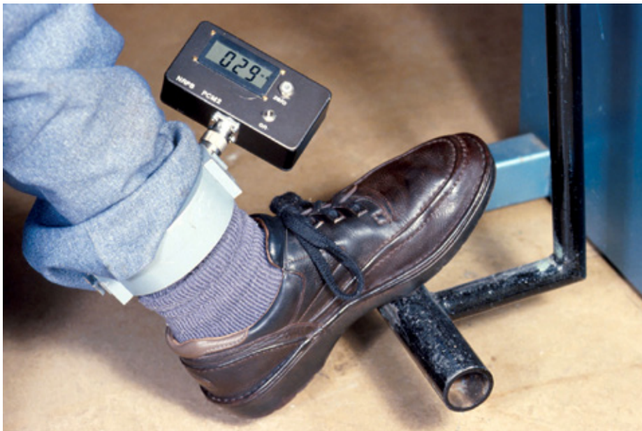
Figura C7 – O clemă ampermetrică utilizată pentru a măsura curentul indus în membre atunci când se utilizează un aparat de sudură dielectric de 27 MHz
