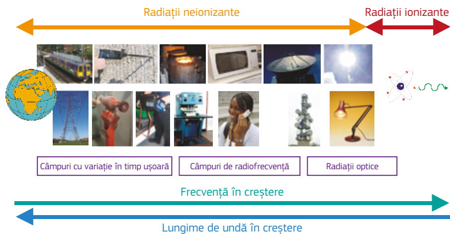
Figura 3.1. – Reprezentare schematică a spectrului electromagnetic indicând o serie de surse tipice
