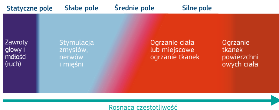
Rysunek 2.1 – Skutki oddziaływania pola elektromagnetycznego o różnych zakresach częstotliwości fal (zakresy częstotliwości nie są przedstawione na skali)
