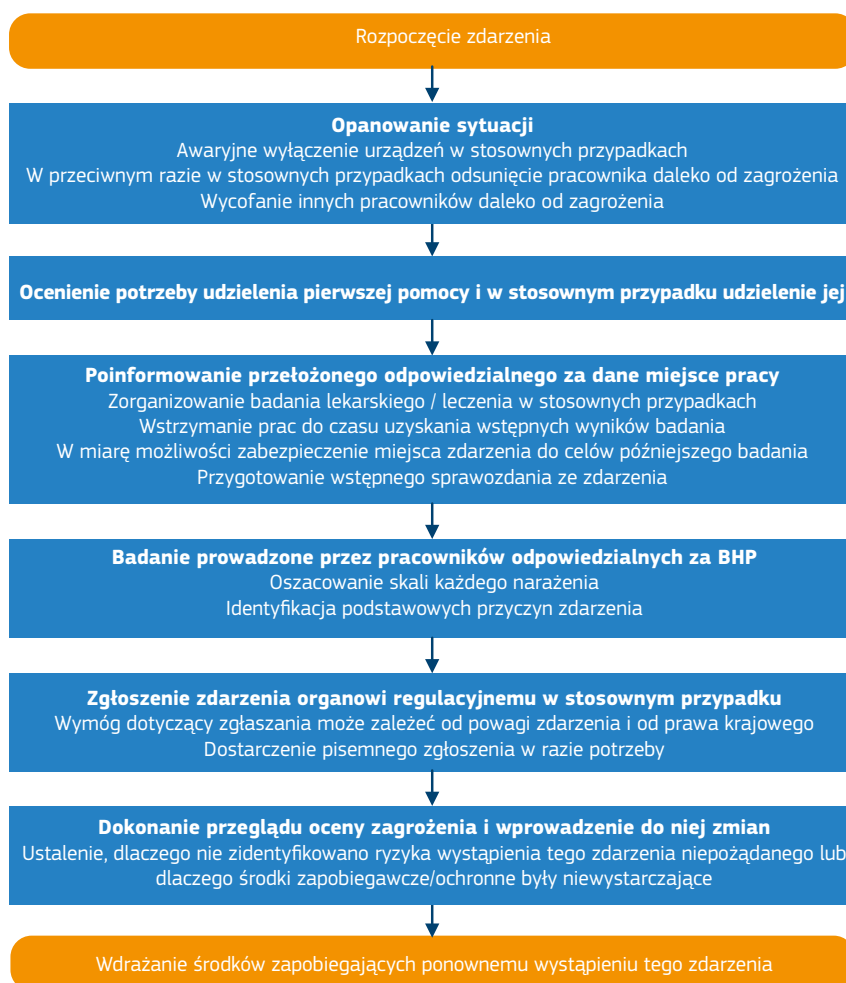
Rysunek 10.1 Ciąg wydarzeń w ramach typowej reakcji na zdarzenie
