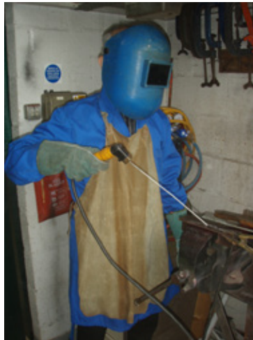
Rysunek 9.11 – Przykłady dobrej i złej praktyki w zakresie trzymania kabla do spawania łukowego
