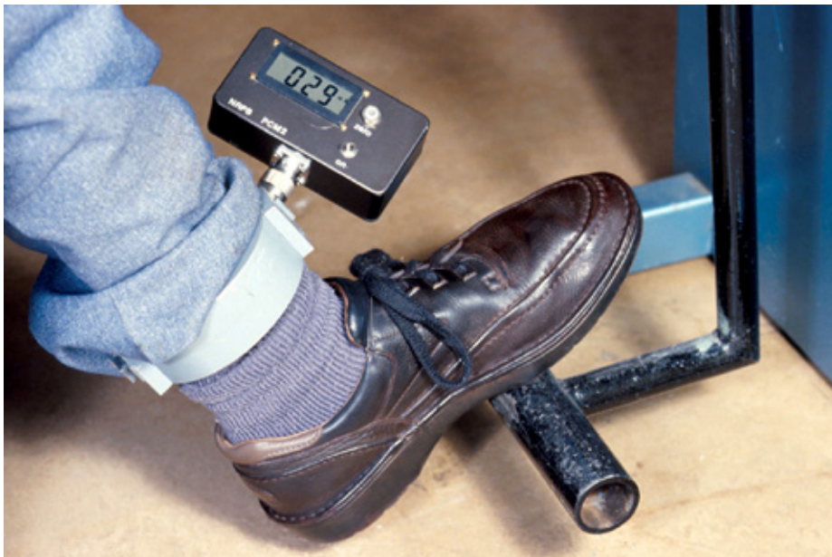
Rysunek C7 – Zastosowanie amperomierza cęgowego do pomiaru prądu kończynowego podczas używania zgrzewarki dielektrycznej pracującej na częstotliwości 27 MHz
