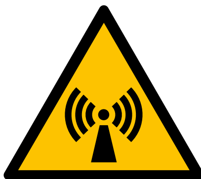
Rysunek 9.6 – Standardowe znaki ostrzegawcze pojawiające się często w związku z polem elektromagnetycznym
