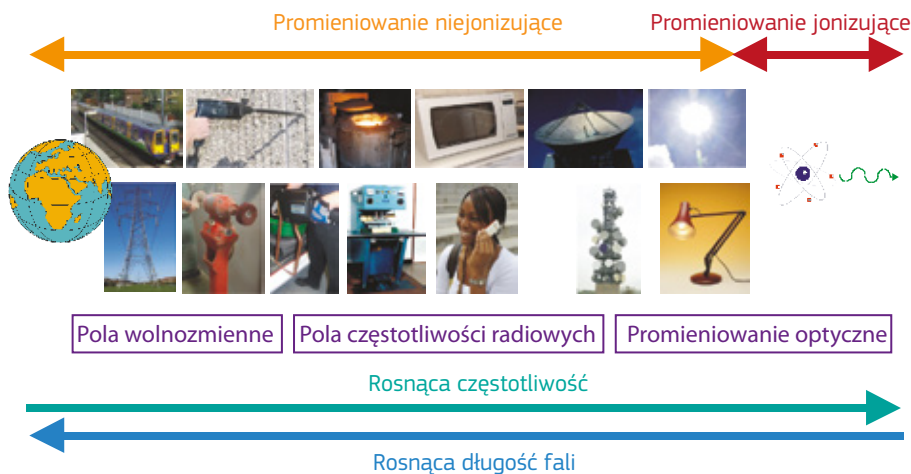
Rysunek 3.1 – Schemat widma elektromagnetycznego pokazujący niektóre typowe źródła
