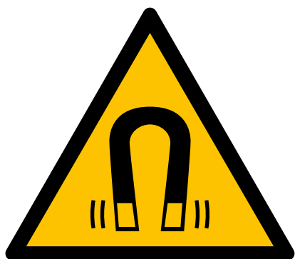
Rysunek 9.6 – Standardowe znaki ostrzegawcze pojawiające się często w związku z polem elektromagnetycznym
