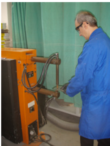
Rysunek 9.10 – Ilustracje dobrej praktyki i złej praktyki przy organizacji stanowiska pracy przy zgrzewarce punktowej i rozważaniu umiejscowienia operatora
