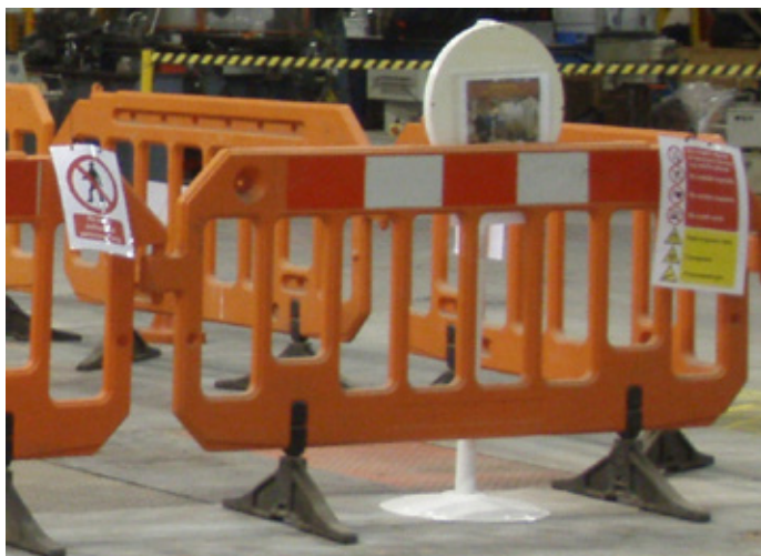
Rysunek 9.5 – Tymczasowe bariery i znaki ostrzegawcze ograniczające dostęp do silnych pól wytwarzanych przez tymczasową instalację
