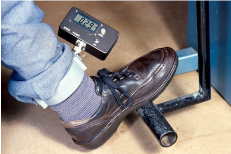
Figura C7 — Klamp tal-kurrent użata sabiex jitkejjel il-kurrent tad-dirgħajn u r-iglejn meta jintuża welder dielettriku ta' 27 MHz
