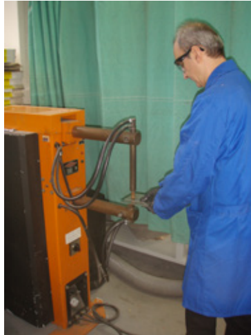
Slika 9.10. – Prikaz dobre i loše prakse prilikom uređenja radne stanice za točkasti zavarivač i razmatranja položaja rukovoditelja
