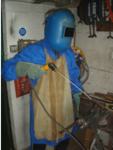
Slika 9.11. – Primjeri dobre i loše prakse usmjeravanja kabela za lučno zavarivanje
