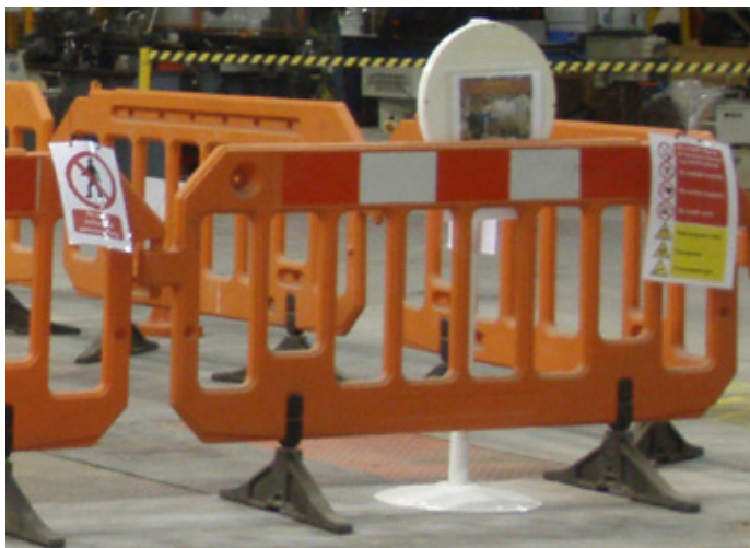
Illustration 9.5 — Barrières temporaires et signaux d'avertissement visant à limiter l'accès aux champs puissants générés par une installation temporaire
