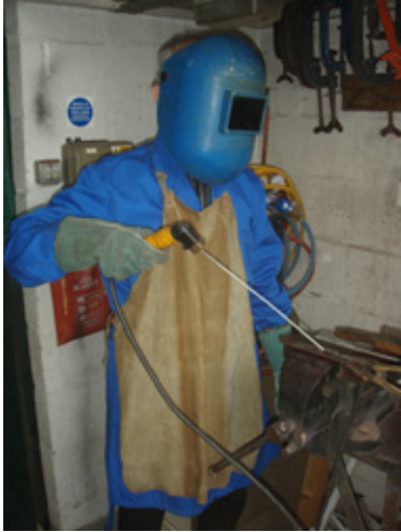
Figur 9.11. Eksempler på god og dårlig praksis ved føring af svejsekabel
