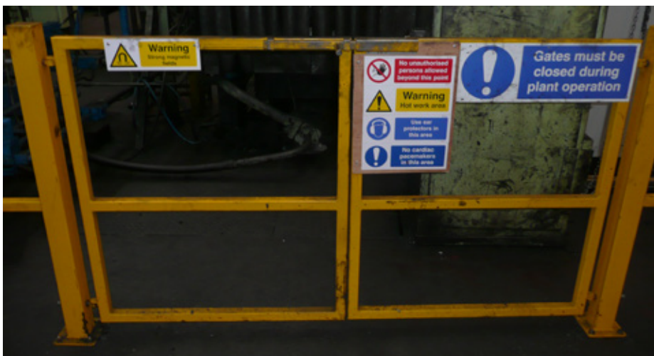
Figur 9.1. Eksempel på simple flytbare afspærringer, der begrænser adgangen til et stærkt magnetisk felt. I dette tilfælde er afspærringen ikke tilsluttet en afbryder, men suppleres af advarselsskilte og organisatoriske foranstaltninger.
