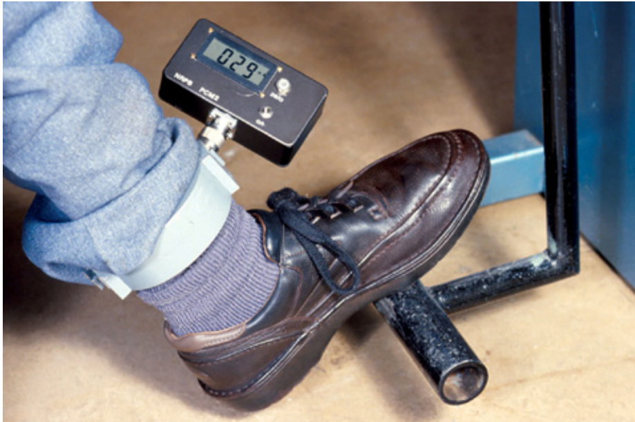
Figur C.7. Et måleinstrument, der anvendes til at måle strømmen i lemmer under anvendelse af en 27 MHz dielektrisk svejser
