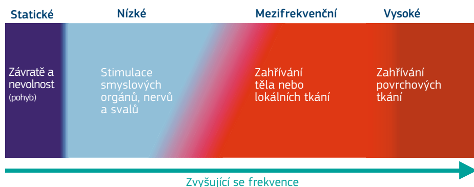
Obrázek 2.1 Účinky EMP v různých frekvenčních pásmech (frekvenční intervaly nejsou znázorněny v měřítku)
