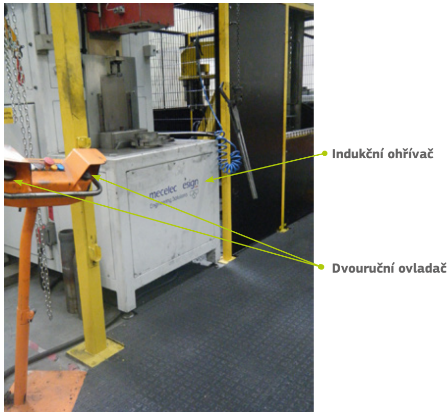
Obrázek 9.4 Dvouruční ovladač používaný k zajištění bezpečné vzdálenosti pracovníka od indukčního ohřívače
