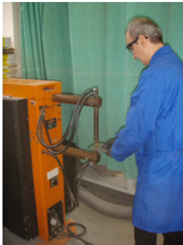
Obrázek 9.10 Ilustrace správného a nesprávného postupu při uspořádání pracovního místa u bodové svářečky a zohlednění místa, kde se nachází obsluha
