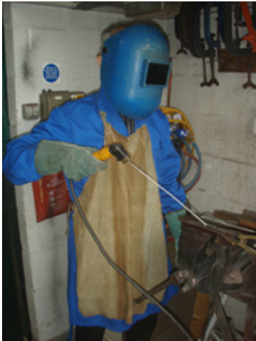
Obrázek 9.11 Příklady správných a nesprávných postupů vedení kabelu u obloukového svařování
