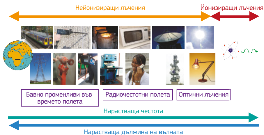
Фигура 3.1 — Схематично представяне на електромагнитния спектър и някои обичайни източници
