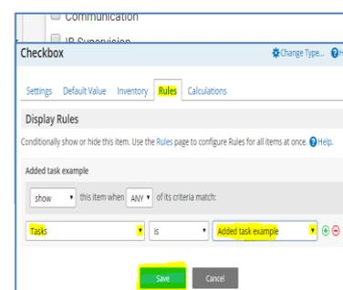
pulse «Rules» (Reglas). En las opciones desplegadas en la parte inferior, seleccione «Tasks» (Tareas) «is» (es) y «Added task example» (Ejemplo de tarea agregada) (al hacer esto se establece una «regla» según la cual esta casilla aparecerá únicamente cuando se seleccione el «Ejemplo de tarea agregada» en el menú Tareas).
