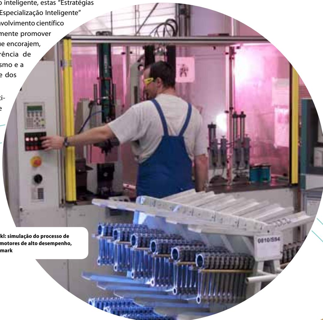
**Sistemas de Corrida Pankl: simulação do processo de fundição de bielas para motores de alto desempenho, Bruck an der Mur, Steiermark**
