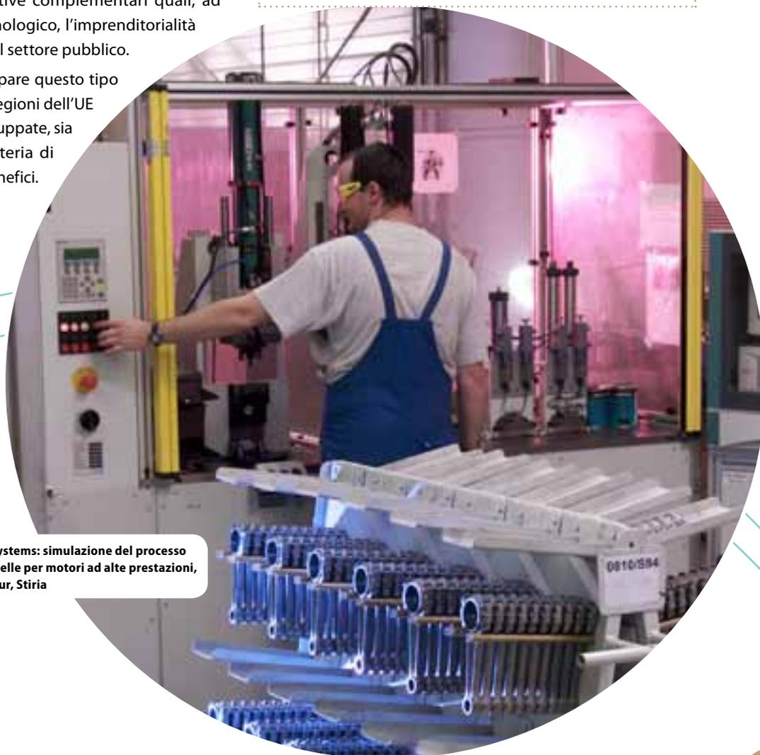
**Pankl Racing Systems: simulazione del processo di forgiatura bielle per motori ad alte prestazioni, Bruck an der Mur, Stiria**
