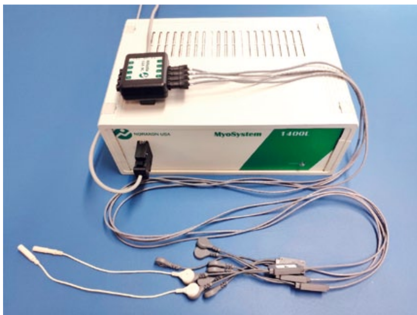
Rycina 6. Ośmiokanałowy aparat elektromiograficzny MyoSystem 1400L wykorzystany w projekcie (Noraxon, Scottsdale, Arizona, USA) (źródło fotografii: materiał własny)
