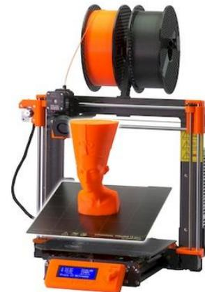
Der 3D-Druck ermöglicht es, dreidimensionale Objekte herzustellen. Vor dem Drucken müssen die Objekte mit Hilfe einer 3D-Modellierungs-Software entworfen werden. Der Druck entsteht nun, indem die Einzelteile des Objekts aufgeschichtet werden. Es ist also eine additive Herstellungstechnik. Die Schichtungsstruktur
