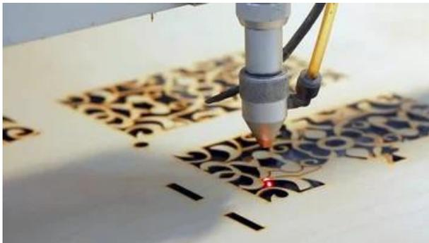
physikalischen Prozessen erzeugt. Serienmäßig werden fokussierbare Hochleistungslaser genutzt, einschließlich des CO<sub>2</sub>-Lasers (ein Gas-Laser). Immer häufiger kommen aber auch Nd: YAG Laser
