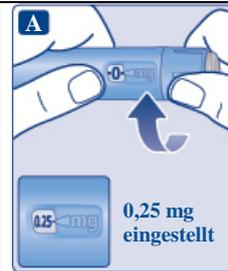
Nur die Dosisanzeige auf Höhe der Dosismarkierung zeigt an, dass 0,25 mg eingestellt wurde. Der Dosiseinstellring macht unterschiedliche Klickgeräusche, je nachdem, ob er vorwärts, rückwärts oder über die 0,25 mg hinaus gedreht wird. Zählen Sie nicht die Klickgeräusche des Pens.
