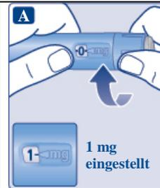
Nur die Dosisanzeige auf Höhe der Dosismarkierung zeigt an, dass 1 mg eingestellt wurde. Der Dosiseinstellring macht unterschiedliche Klickgeräusche, je nachdem, ob er vorwärts, rückwärts oder über die 1 mg hinaus gedreht wird. Zählen Sie nicht die Klickgeräusche des Pens.
