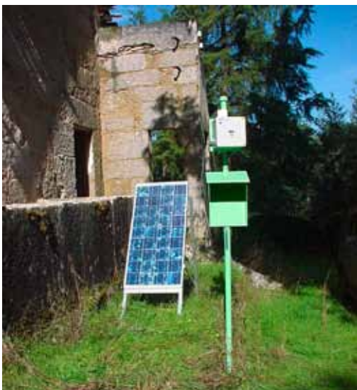
Dosímetro de sítio colocado na zona dos trabalhos da Urgeiriça (Barragem Velha), para detecção dos descendentes do gás Radão ( ^{222}\text{Rn} ) e do gás Torão ( ^{220}\text{Rn} )
