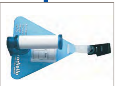
Il campionatore diffusivo a simmetria radiale Radelli®, (Foto: Fondazione Salvatore Maugeri - IRCCS sm )
