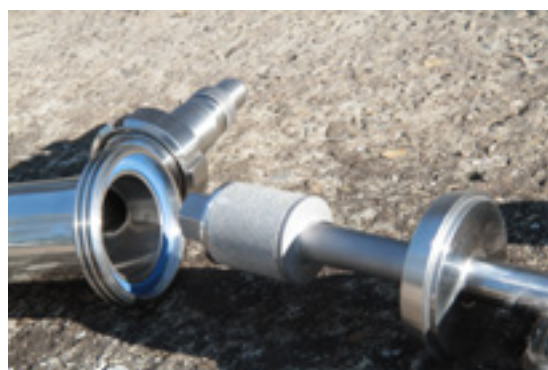
W ramach projektu pilotażowego przetestowano prototyp systemu filtrów stalowych na potrzeby lokalnej produkcji oliwy z oliwek w Toskanii.
