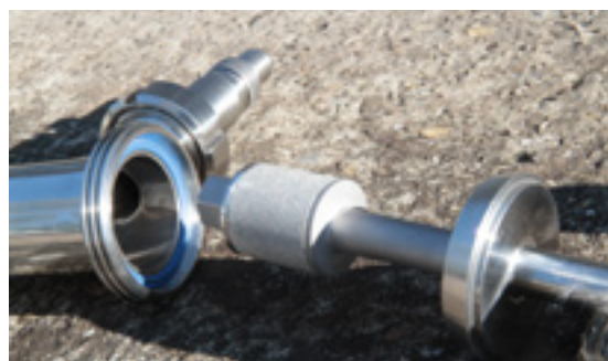
Il progetto pilota ha testato un prototipo di un sistema di filtrazione in acciaio per la produzione di olio d'oliva locale in Toscana.
