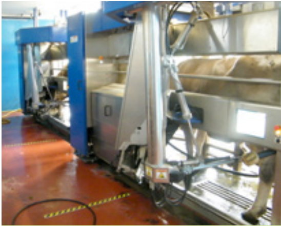
El ordeño robótico aumentó la eficacia y el volumen de la producción lechera en la explotación agraria de carácter familiar.
