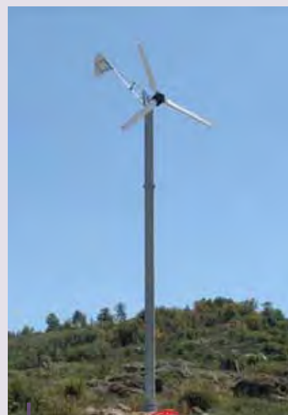
Mikro turbina wiatrowa wytwarzająca prąd. Jej lekkość, małe wymiary i elastyczna konfiguracja sprawiają, że może zostać wykorzystana na obszarach miejskich i wiejskich.
