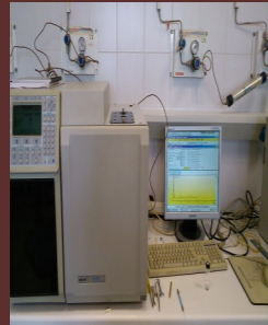
προσδιορισμός των λιπαρών οξέων με αέρια χρωματογραφία
