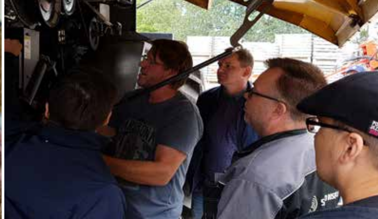
Zemědělci na workshopu MIKÄ DATA při diskusi o tom, jak kalibrovat senzory výnosu na kombajnech k získání přesnějších analýz
