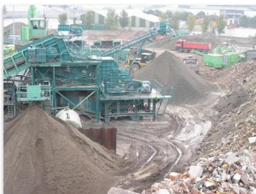
Zariadenie na recykláciu stavebného odpadu a odpadu z demolácie, zdroj: FIR.
