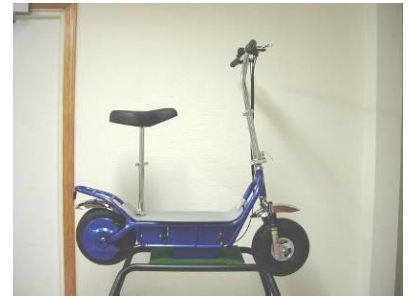
Elektroroller, Höchstgeschwindigkeit: 22 km/h
