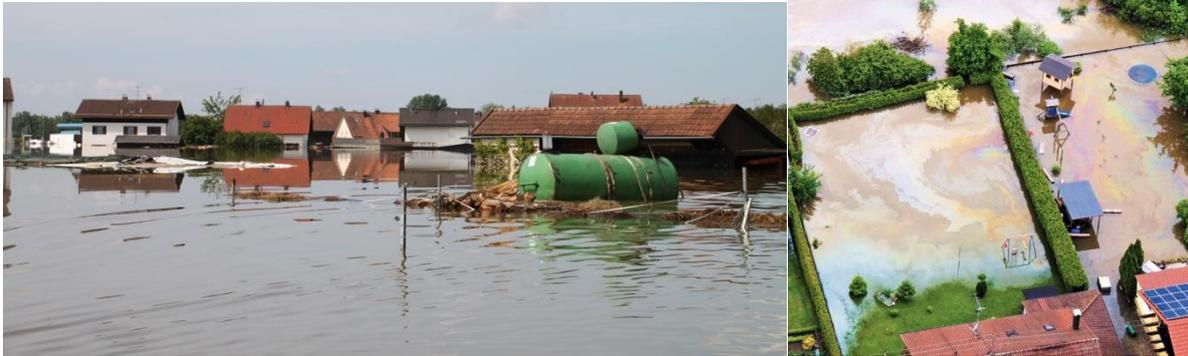
Anhand nachfolgender Tabelle sollen die Folgen der Einwirkungen aus Erdbeben und Überschwemmung auf einen Behälter (einwandig, Lagermedium Heizöl [Dichte 0,95 kg/Liter]) mit den Abmessungen nach EN 12285-2 aus technischer Sicht erläutert werden.
