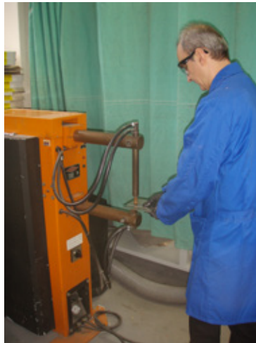
Figuur 9.10 — Illustraties van goede praktijken en slechte praktijken bij de indeling van de arbeidsplaats voor een puntlasmachine en rekening houdend met de positie van de bediener
