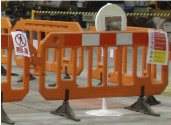
Figuur 9.5 — Tijdelijke afbakeningen en waarschuwingsborden om toegang tot sterke velden opgewekt door een tijdelijke installatie te beperken
