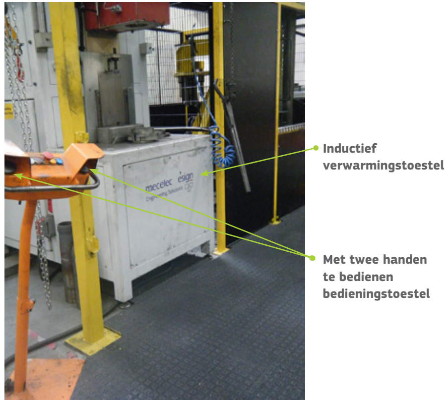
Figuur 9.4 — Met twee handen te bedienen bedieningstoestel, gebruikt om de werknemer gescheiden te houden van inductief verwarmingstoestel
