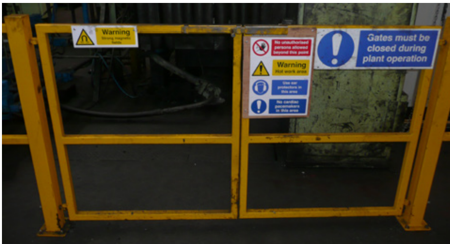
Figuur 9.1 — Voorbeeld van een eenvoudige afneembare beschermplaat om toegang tot een sterk magnetisch veld te beperken. In dit geval is de beschermplaat niet vergrendeld, maar aangevuld met waarschuwingsborden en organisatorische maatregelen
