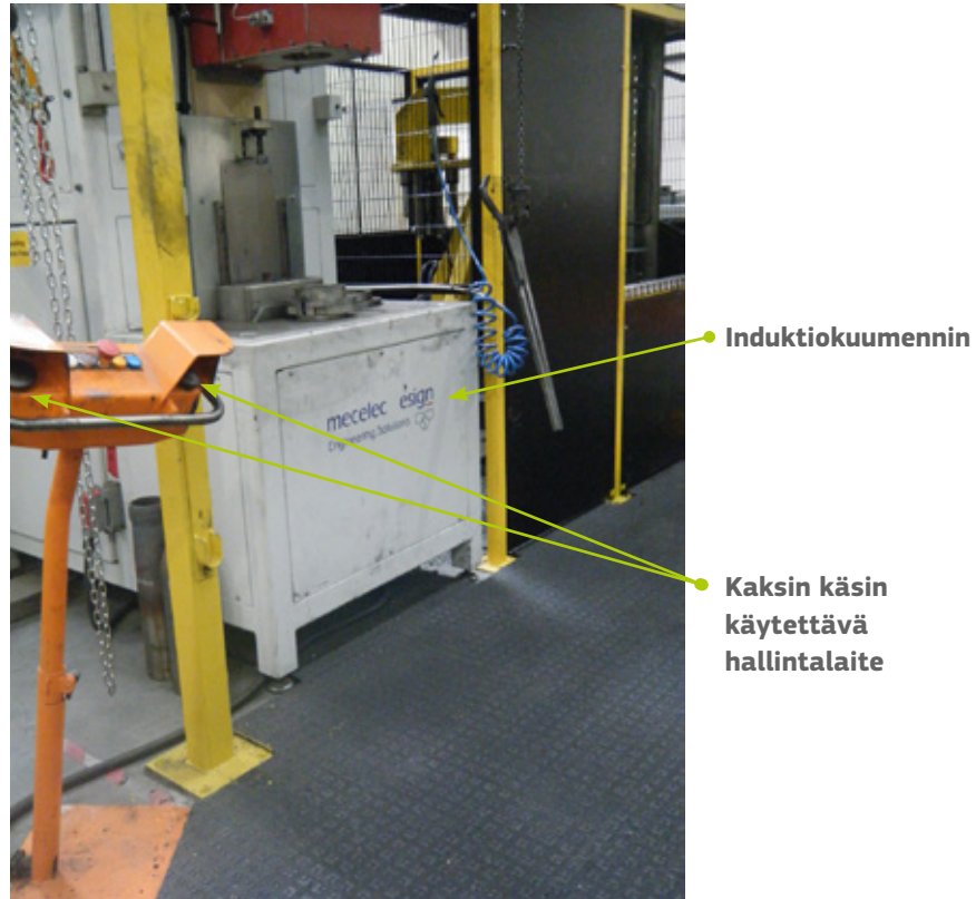
Kuva 9.4 Kaksin käsin käytettävä hallintalaite, jolla varmistetaan, että työntekijä ei ole kosketuksissa induktiokuumentimeen
