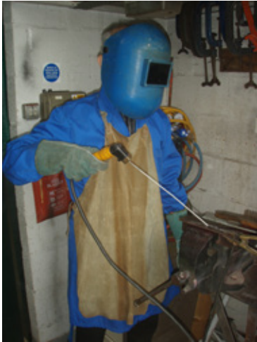
Kuva 9.11 Esimerkit hyvästä ja huonosta työtavasta kaarihitsauskaapelin reitityksessä
