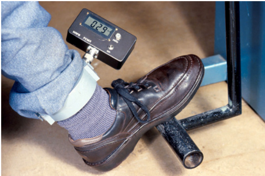
Kuva C7 Virtapihti, jolla mitataan raajassa kulkevaa virtaa käytettäessä 27 MHz:n suurtaajuuksista hitsauslaitetta
