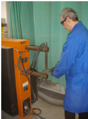
Kuva 9.10 Havainnollistavat esimerkit hyvästä ja huonosta työtavasta, kun järjestetään pistehitsauskoneen työpistettä ja suunnitellaan koneen käyttäjän sijaintia
