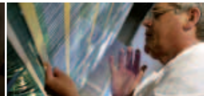
Assemblage des tuiles scintillantes dans le calorimètre Hadron du détecteur LHCb. © CERN
