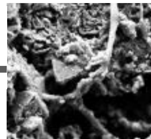
Microphotographie d'un détail de la structure en marbre incrusté de poussière noire – Monument à la Liberté, Riga (Lituanie).
