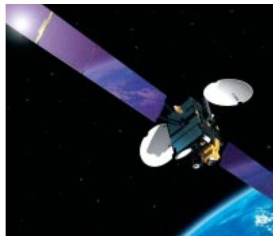
Mis sur orbite en juillet 2001, le satellite de communication Artemis (Advanced Relay and Technology Mission Satellite) sert de relais d'intercommunication entre des stations d'émissions terrestres et des postes mobiles. Sa nouvelle technologie de transmission par laser lui permet également de tester les communications inter-satellites. ©ESA
