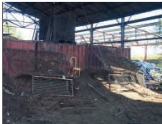
Crivagem em pavilhão coberto (a crivagem é feita com as molas de colchões reutilizados)
