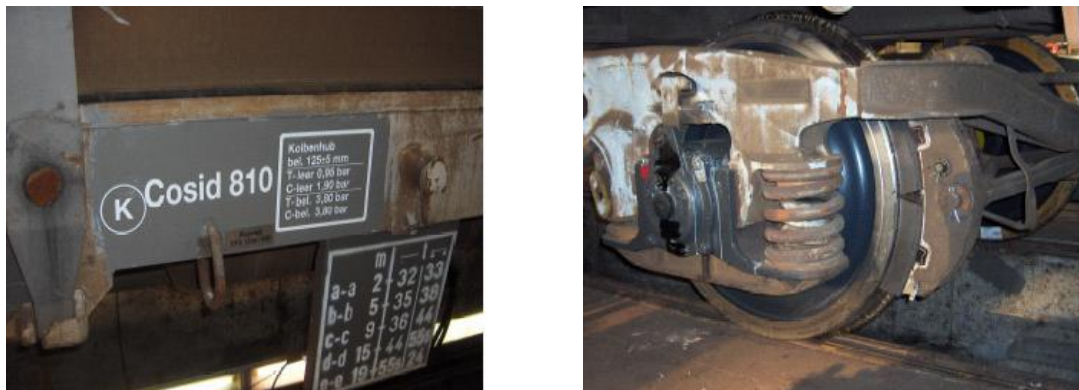
Abbildung 3.2. Bild eines Güterwagens, welcher mit K-Sohlen umgerüstet wurde. Solch alte Güterwagen sind nun so leise wie moderne Reisezugwagen.
